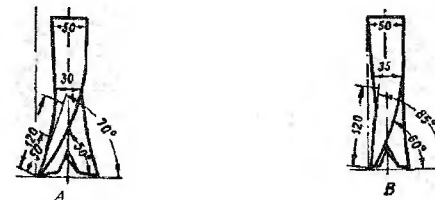
рис. 18. Профили заправки долот РХ для пород различной твердости.
