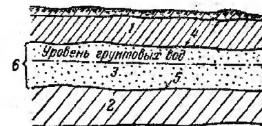
Рис.1. Схема строения водоносного пласта
